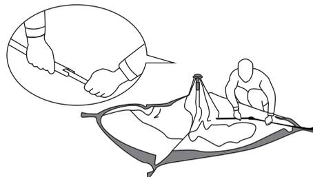
4. 上部プラスチックを片手で持ち、テントを持ち上げ、固定ポールをもう片方の手でカチッと音がするまで押し下げます。これでテントが完全に広がります。
